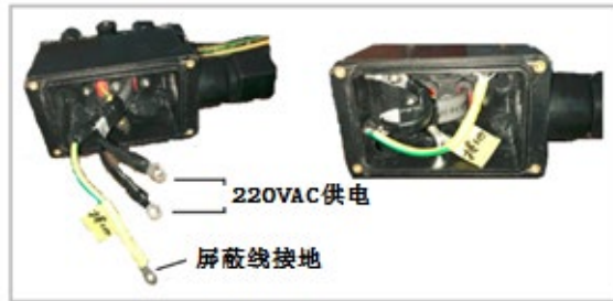
图 12 电伴热电源接线盒
